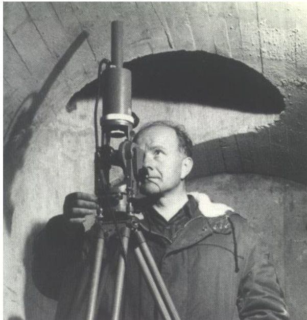
figura 3.22. Orientação num túnel com um giroscópio montado num teodolito
